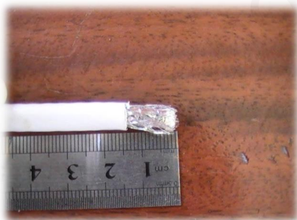
ภาพ 1 แสดงการปอกสายนำสัญญาณ RG- 6 นำฉนวนด้านนอกออก ที่มา: นายมานพ แสงสว่าง
