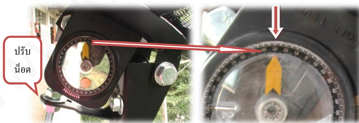
ภาพ 19 แสดงการใช้ตัววัดมุม (Angle level) วัดมุมหน้าจานให้ได้ 30 องศา
