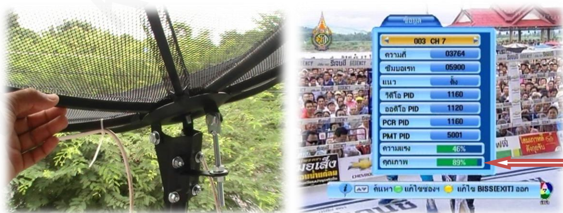
ภาพ 25 แสดงการปรับหน้าเพื่อให้ระดับคุณภาพของสัญญาณที่เปอร์เซ็นต์สูงสุด
