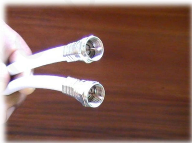
ภาพ 5 แสดงสายนำสัญญาณ RG- 6 ที่พร้อมใช้งาน
