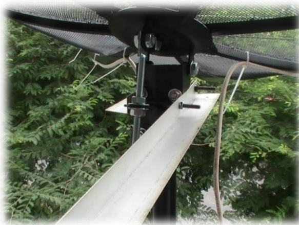
ภาพ 22 แสดงลักษณะการประกอบอคูมิเนียมจากกับคอกงาน
