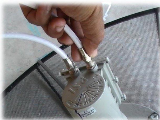
ภาพ 6 แสดงการต่อสายนำสัญญาณ RG- 6 กับหัวรับสัญญาณ LNB
