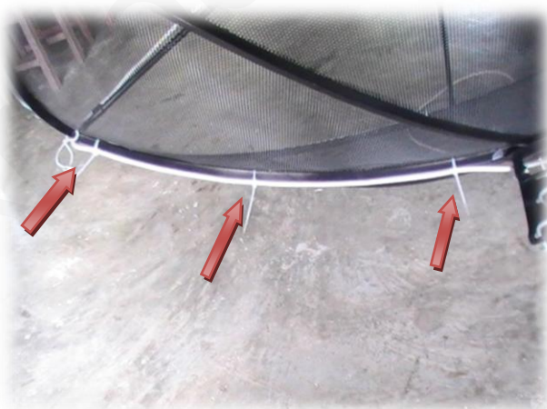
ภาพ 9 แสดงรัดสายนำสัญญาณ RG- 6 ด้วยสายรัดพลาสติก (Cable tie) ด้านหลังงาน ที่มา: นายมานพ แสงสว่าง
