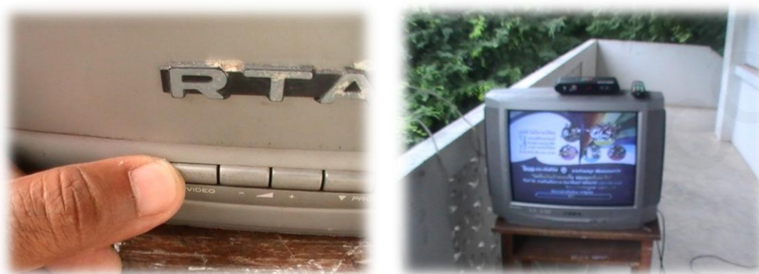
ภาพ 16 แสดงการกดปุ่ม TV/VIDEO ที่โทรทัศน์เพื่อเลือกรับช่องสัญญาณจาก เครื่องรับสัญญาณดาวเทียม (Receiver)
